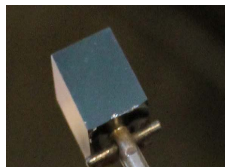
Рис. 7. Стекланный куб с алмазом после молдинга в халькогенидном стекле - иммерсионной среде.
