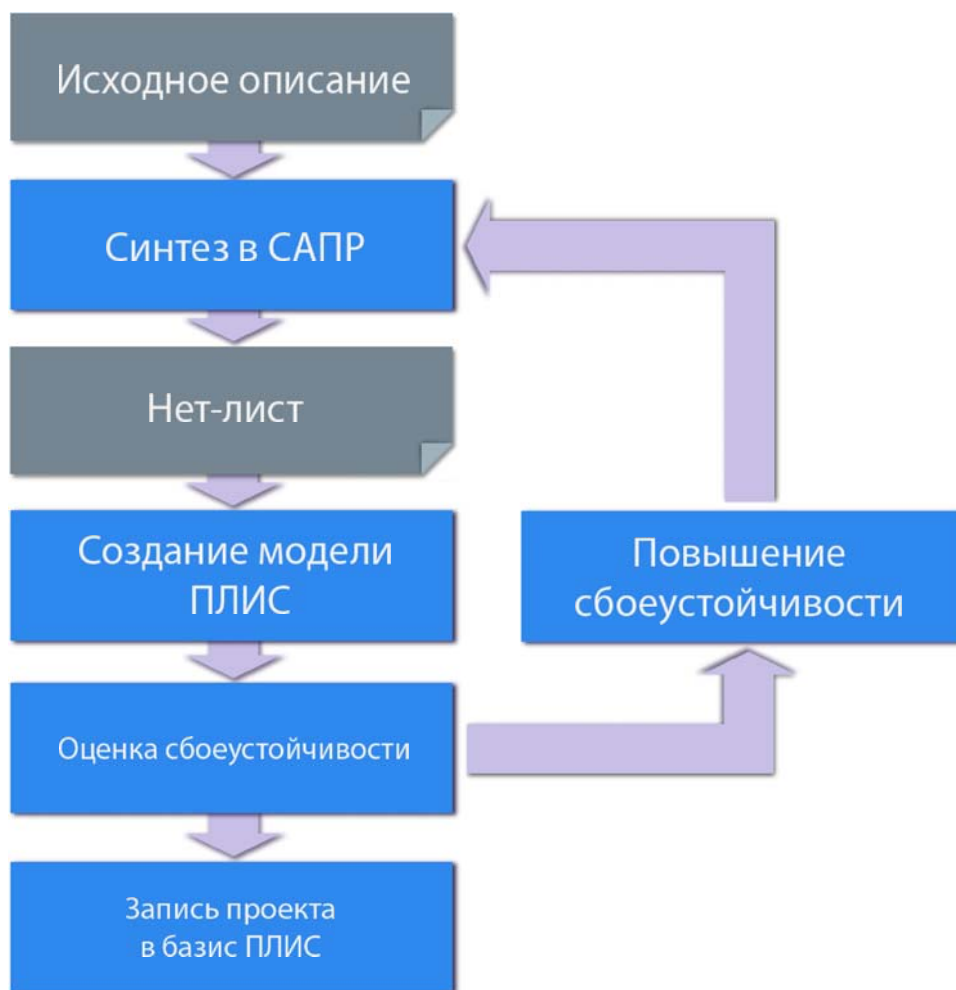
Рис. 1. - Маршрут проектирования сбоеустойчивых схем ПЛИС на основе незащищенной элементной базы.
