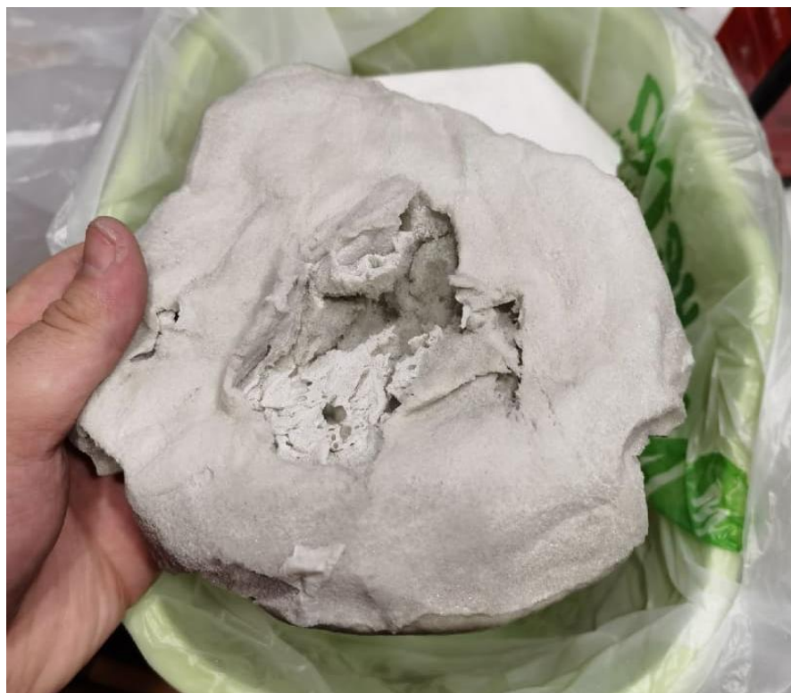
Рис. 5. – Пористая структура материала при твердении в комнатной температуре после добавления воды во время увеличения объема
