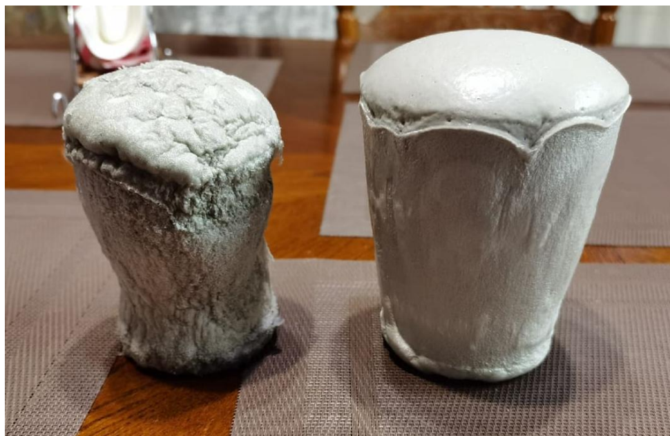
Рис. 3. – Сравнение увеличения объема при расширении ЗБ при комнатной температуре (слева) и морозильной камере (справа).
