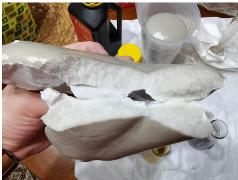
Рис. 4. – Пористая структура материала при твердении в комнатной температуре.
