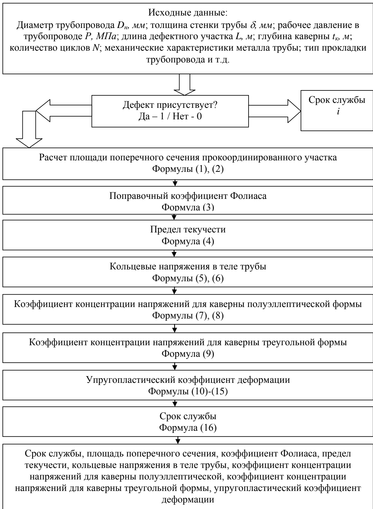
Рис. 1. - Блок-схема программного продукта «Расчет предельного срока службы трубопровода с дефектом»
