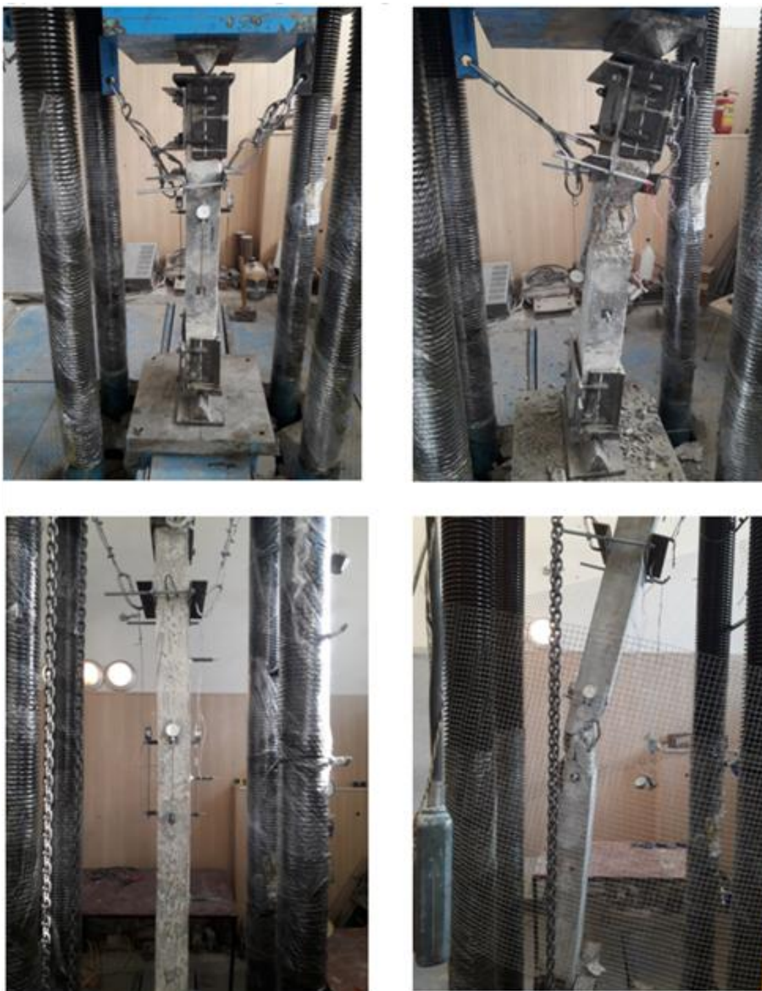
Рис. 1. – Общий вид колонн: верхний ряд – длиной 120 см, нижний ряд – длиной 240 см; слева – до разрушения, справа – после разрушения
