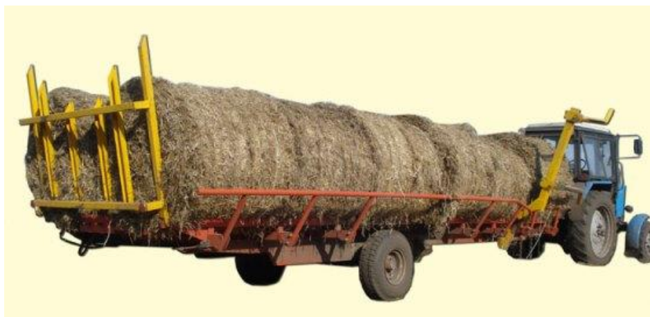
Рис.1. - Самозагружающийся прицеп круглых тлюков
