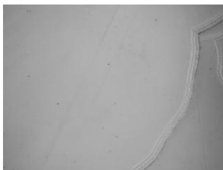
Рис. 3. – Поверхность твердого раствора GaInAsBi с точками выхода дислокаций. Увеличение \times 200
